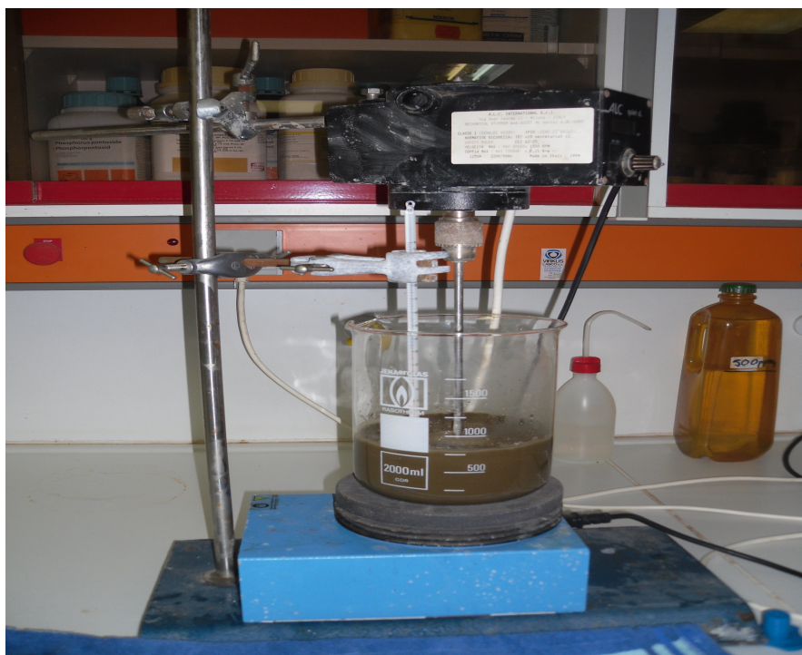
Εικόνα 5.8 Πειραματική διάταξη με αναδευόμενο αντιδραστήρα
