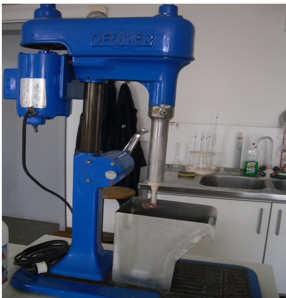
Εικόνα 5.4 Αναδευόμενος αντιδραστήρας
