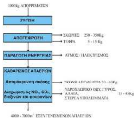
Σχήμα 2.6: Διάγραμμα ροής μιας τυπικής σύγχρονης εγκατάστασης αποτέφρωσης αστικών απορριμμάτων, (Πηγή: Γιδαράκος Ε., 2006).
