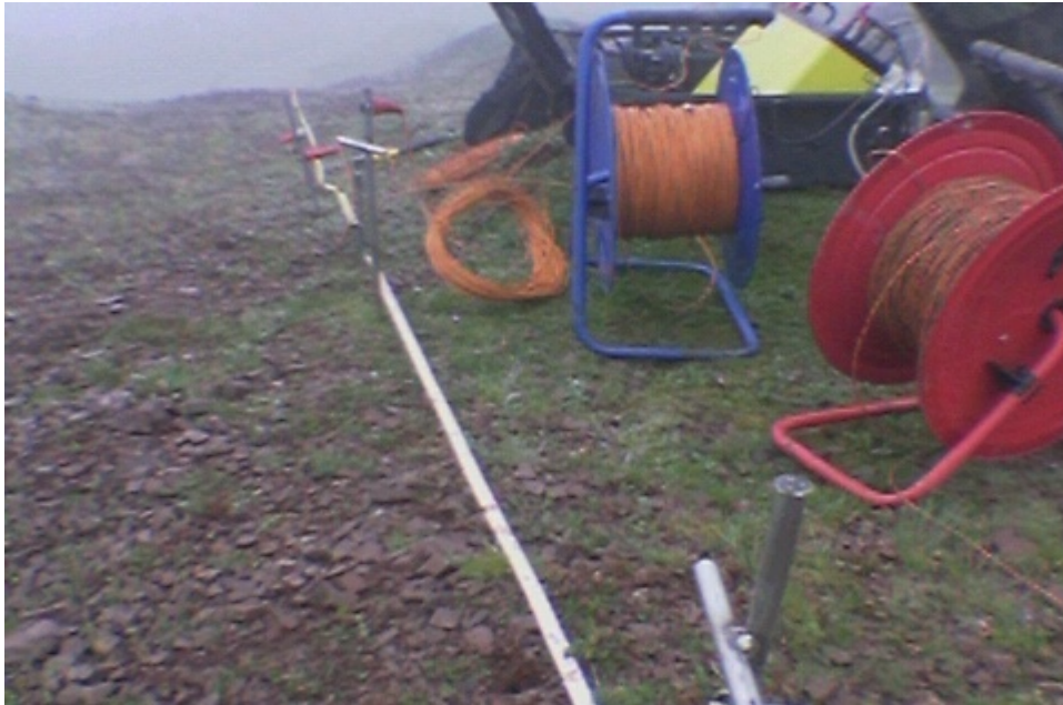
Σχήμα 3.31: Φωτογραφία κατά την διεξαγωγή των επιτόπιων μετρήσεων για την βαθμονόμηση της ηλεκτρικής τομογραφίας.
