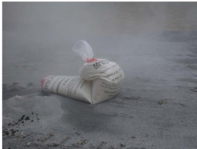
Σχήμα 1.5. Πετρελαιοαμμωνίτης ANFO που χρησιμοποιείται στο λατομείο Γουρνών.
