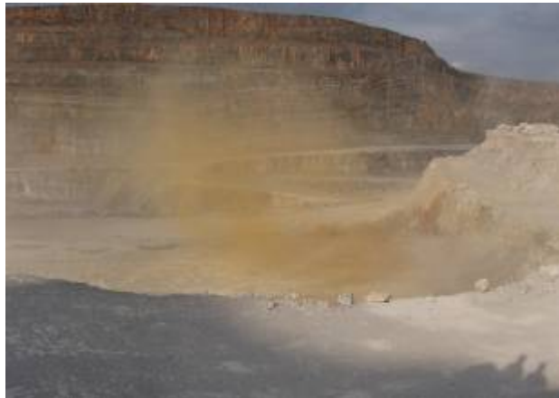
Σχήμα 2.14. Επιβλαβή αέρια στο μέτωπο εξόρυξης μετά την ανατίναξη.
