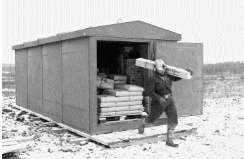
Σχήμα 2.3. Μεταφερόμενη αποθήκη εκρηκτικών για Τεχνικά Έργα από χάλυβα και εσωτερική επένδυση από ξύλο, της DYNNO NOBEL Σουηδίας. Αποθηκευτική ικανότητα από 500 – 10.000 kg. Κατασκευή σύμφωνα με τους σουηδικούς κανονισμούς.
