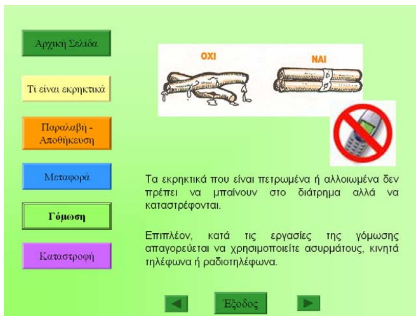
Σχήμα 6.10. Απαγορευτική χρήση αλλοιωμένων εκρηκτικών και χρήσης ασυρμάτων και κινητών.
