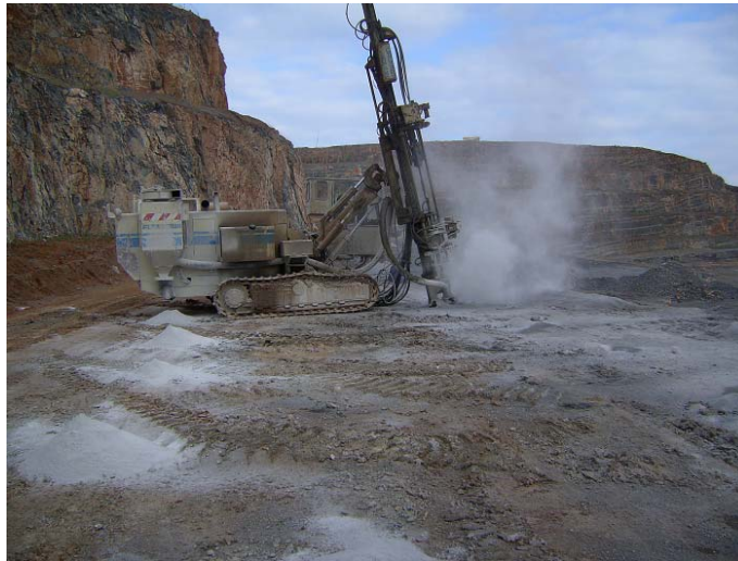
Σχήμα 1.1. Διατρητικό μηχάνημα στο λατομείο Γουρνών.
