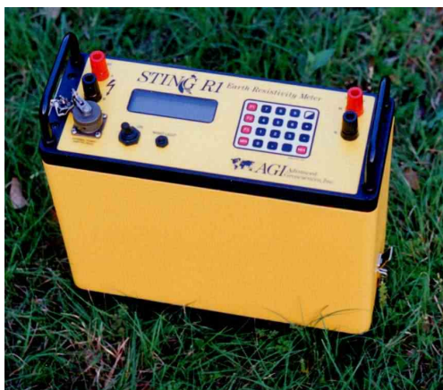
Σχήμα 3.8: Ο μετρητής αντίστασης STING R1 (Advanced Geosciences, Inc, 1999)
