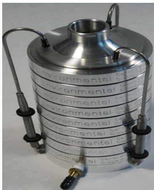
Εικόνα 12: Το όργανο του διαχωριστή πρόσκρουσης σωματιδίων (8 σταδίων) Andersen.
