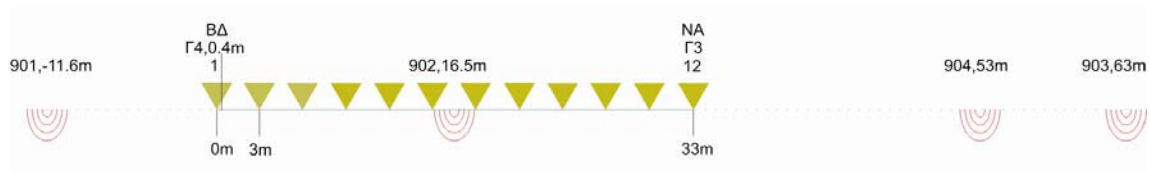
Σχήμα 3.4: Σχηματική παράσταση της γραμμής μελέτης line 900 ΒΔ→ΝΑ διεύθυνσης. Διακρίνονται τα 12 γεώφωνα και οι τέσσερις θέσεις της πηγής.
