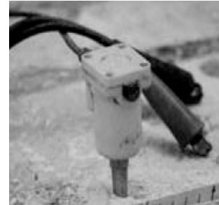
Σχήμα 3.1: Γεώφωνο καταγραφής σεισμικών κυμάτων (Foti, 2003).
