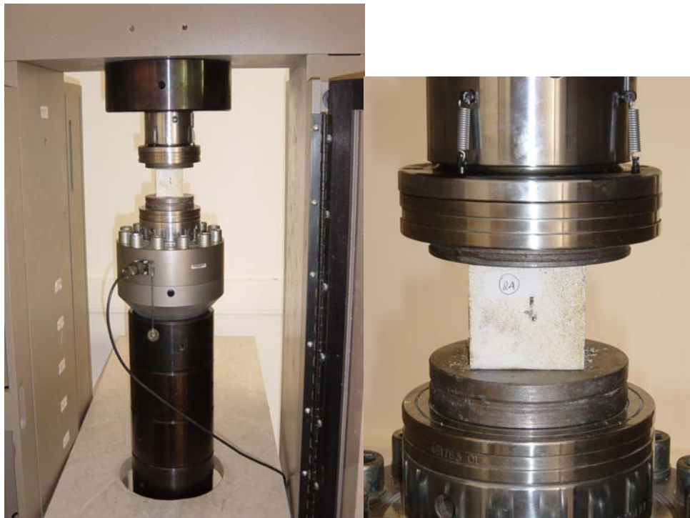
Σχήμα 4.2: Εικόνα δοκιμίου σε φόρτιση
