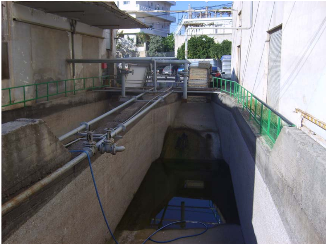
Εικόνα 1-2 Λεκάνη στην οποία απορρίπτονται τα πορτοκάλια για την έκπλυση τους
