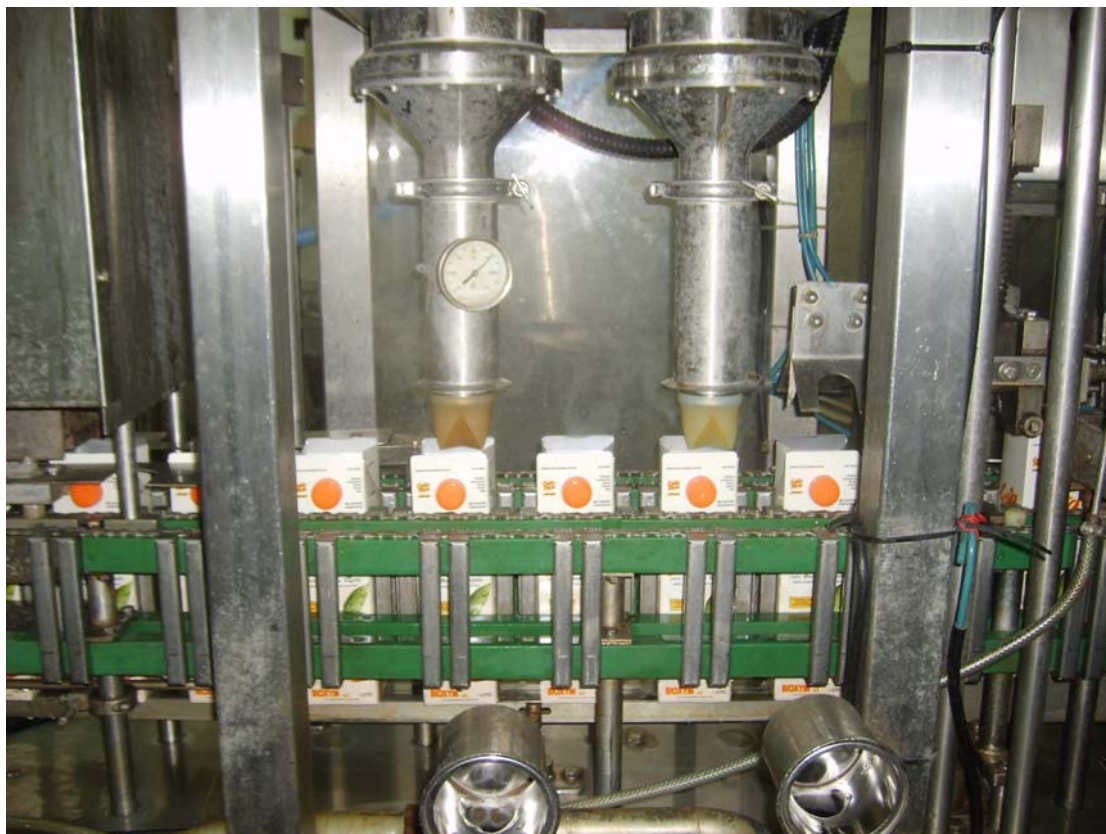
Εικόνα 1-6 Συσκευασία χυμού πορτοκαλιού από μηχανή γεμίσματος υγρών
