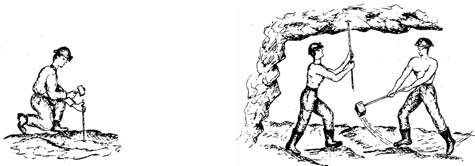
Σχήμα 2.7. Όρυξη διατρήματος με στέλεχος και σφύρα (Μούσουλος 1956)
