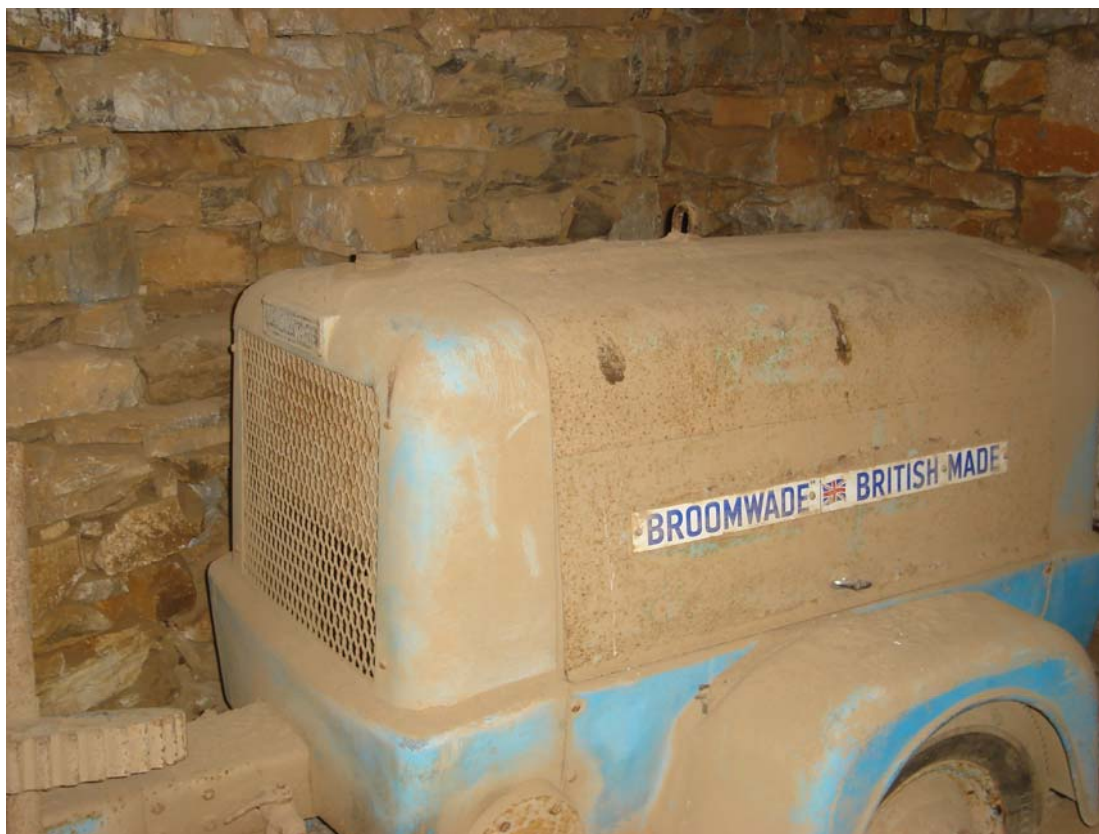
Εικόνα 2.7. Άποψη του κομπρεσέρ της αερόσφυρας που χρησιμοποιήθηκε από τους σμυριδεργάτες. Βρίσκεται σε αποθήκη στην είσοδο του ορυχείου.
