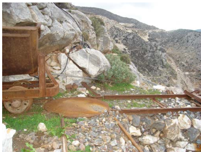
Εικόνα 2.12 Κόμβος με δίσκο περιστροφής
