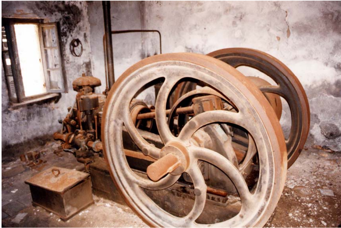
Εικόνα 2.23: Μηχανή κίνησης Blackstone του 1925 (βενζινοκίνητη ισχύος 40Hp) μέσα στο μηχανοστάσιο της Στραβολαγκάδας.
