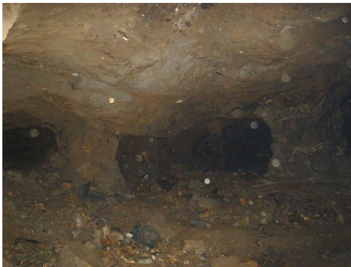
Εικόνα 2.6. Διακρίνονται οι θάλαμοι και στύλοι στο ορυχείο της Σαραντάρας
