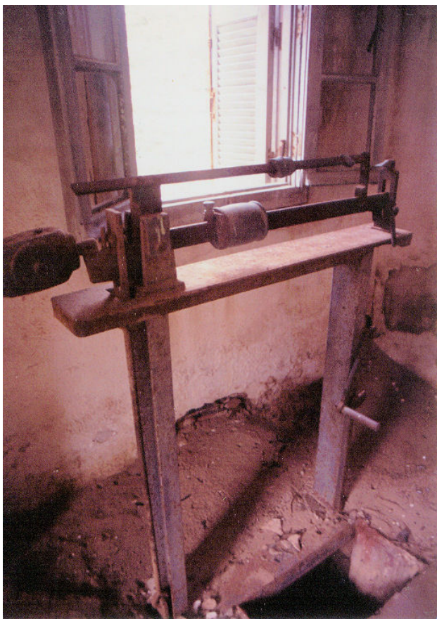
Εικόνα 2.26: ότι απέμεινε από την ζυγαριά της Στραβολαγκάδας. Από έξω περνούσε το βαγόνι και ζυγιζόταν.
