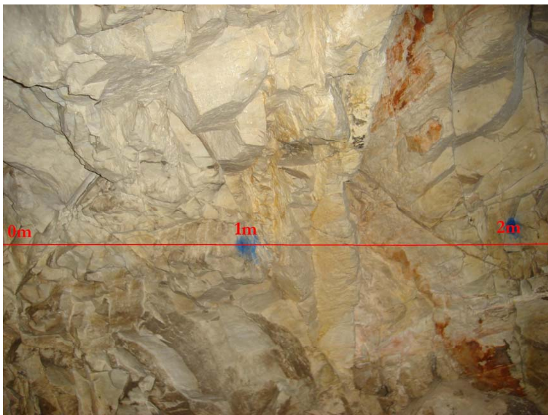
Εικόνα 3.4. Δυο διαδοχικά δειγματοληπτικά παράθυρα στα οποία διακρίνονται οι ασυνέχειες του πετρώματος
