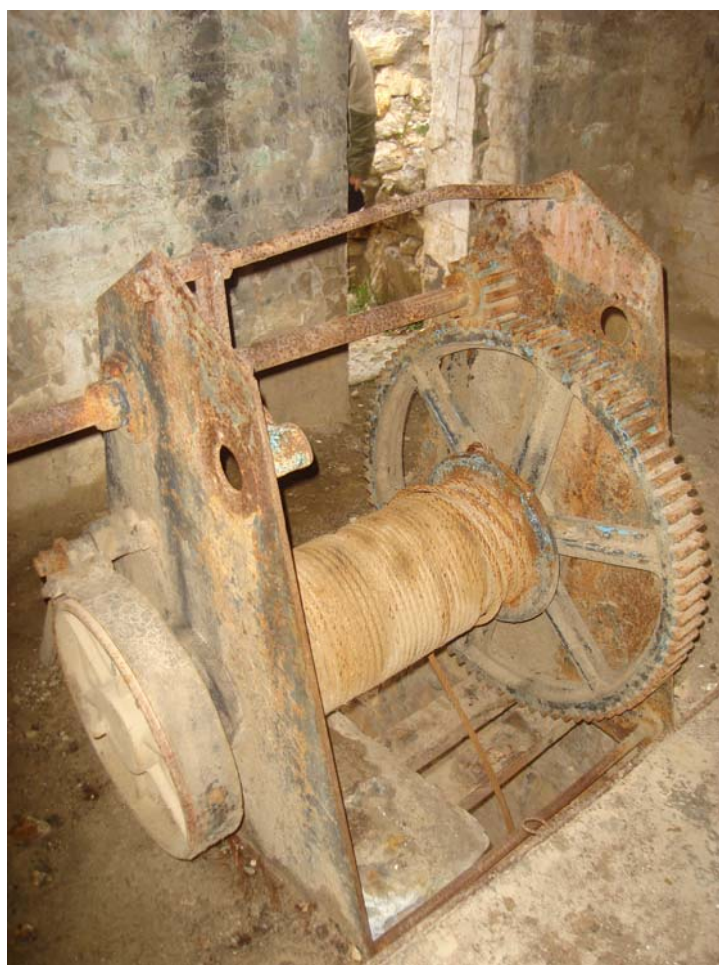
Εικόνα 2.30: Μηχανισμός ρυμούλκησης βαγονιών στη Σαραντάρα .
