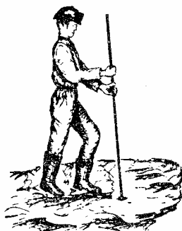
Σχήμα 2.6. Όρυξη κατακόρυφου διατρήματος με ράβδο διάτρησης (Μούσουλος 1956)
