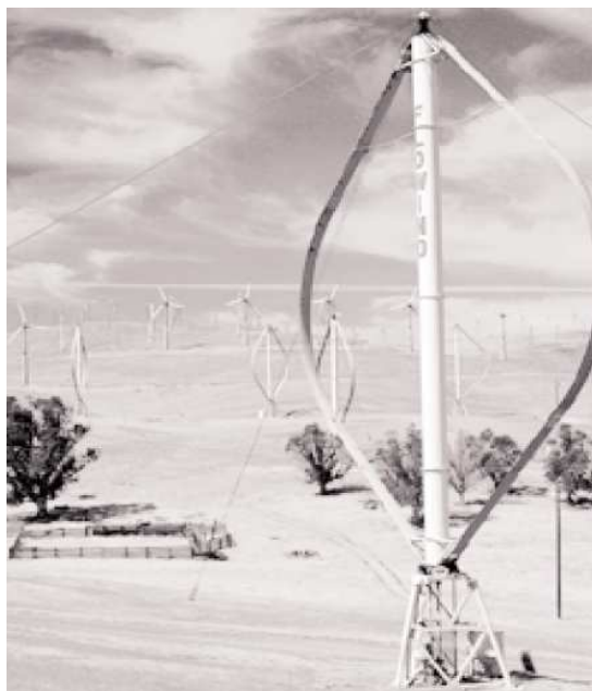
Σχήμα 2.11: Ανεμογεννήτριες κατακόρυφου άξονα τύπου Darrieus
