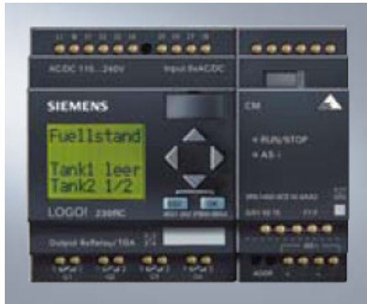
Σχήμα 2.8 Το “LOGO!” με το KNX/EIB communication module
