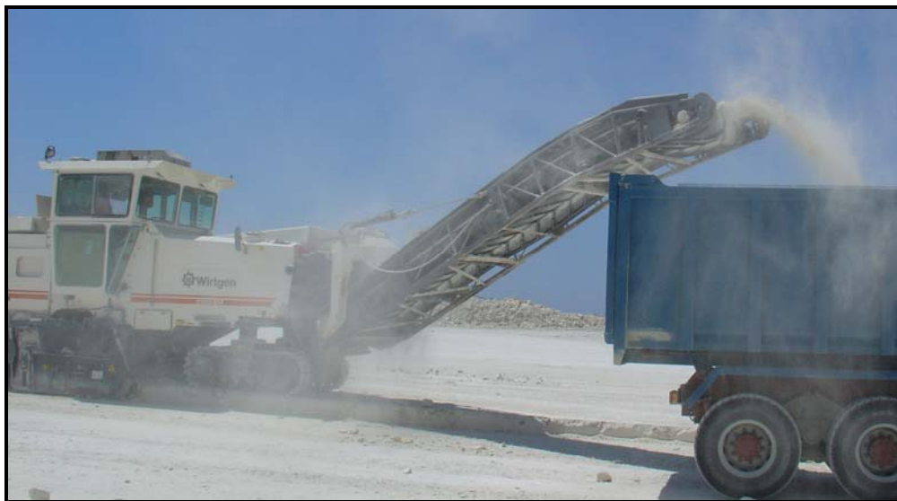
Σχήμα 4.13 Ο βραχίονας του Surface Miner 2200 SM
