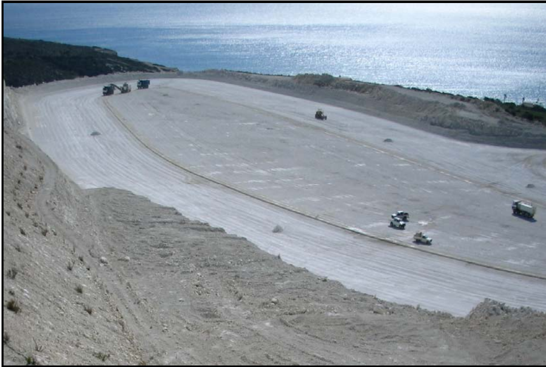
Σχήμα 7.2 Εξόρυξη ασβεστολίθου με το Surface Miner 2200 SM σε λατομείο της Κυπριακής Εταιρείας Τσιμέντων Ltd
