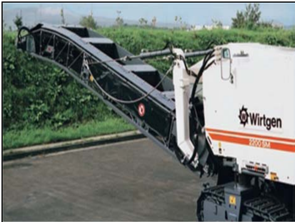
Σχήμα 4.8 Ανωδομή του Surface Miner 2200 SM (Wirtgen, 2007)
