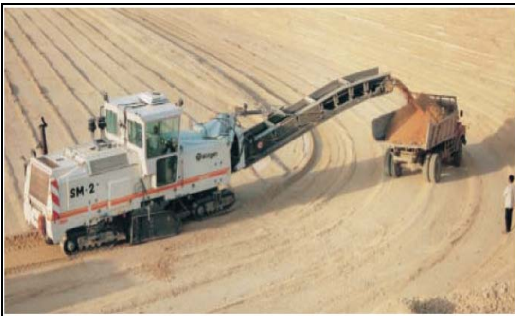
Σχήμα 4.19 Εκμετάλλευση λατομείου με το Surface Miner 2200 SM
