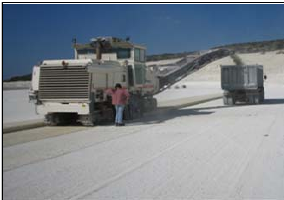
Σχήμα 4.21 Διαδικασία Φόρτωσης με Surface Miner 2200 SM
