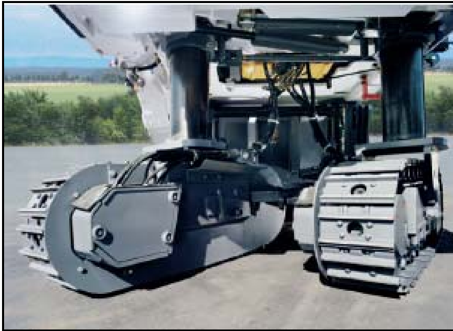
Σχήμα 4.6 Υποδομή του Surface Miner (Wirtgen, 2007)
