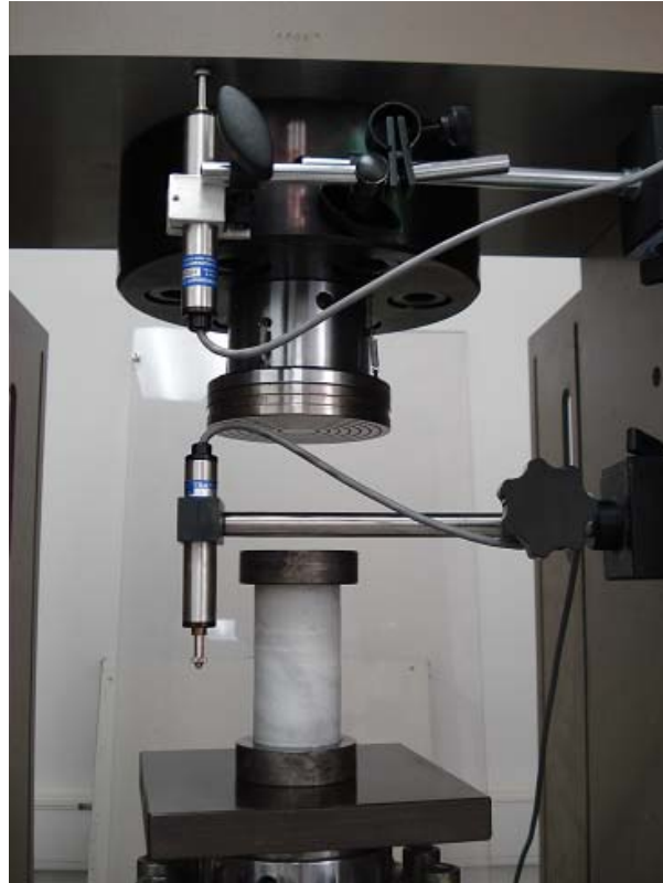
Σχήμα 3.3: Δοκιμή Μονοαξονικής Θλίψης σε μάρμαρο Διονύσου στη συσκευή φόρτισης MTS
