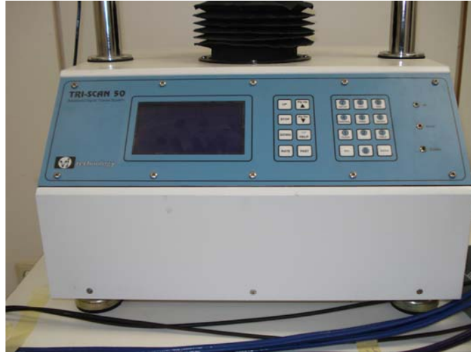
Σχήμα 2.14: Κονσόλα ελέγχου της συσκευής φόρτισης Triscan 50kN
