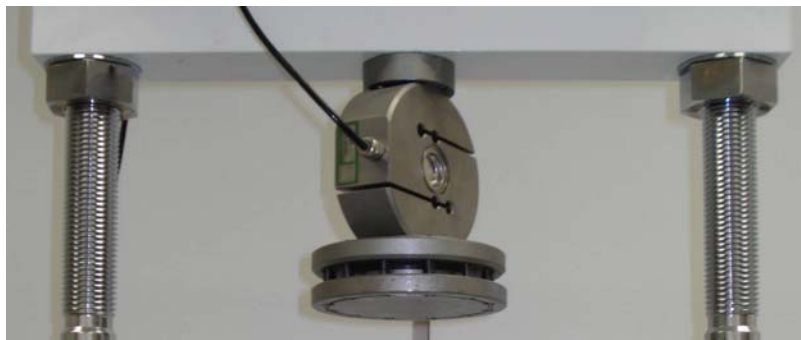
Σχήμα 2.15: Εξωτερικό κελί φορτίου 50kN και σφαιρική κεφαλή
