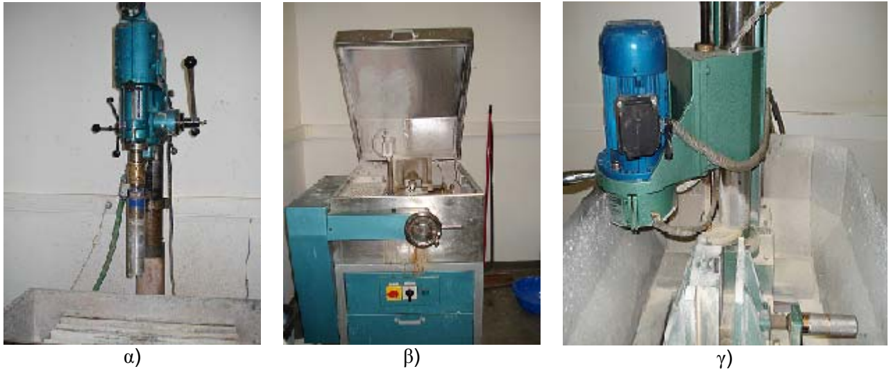
Σχήμα 3.2: α) Εργαστηριακός πυρηνολήπτης δοκιμίων, β) Εργαστηριακός δίσκος κοπής δοκιμίων, γ) Εργαστηριακός λειαντής δοκιμίων.
