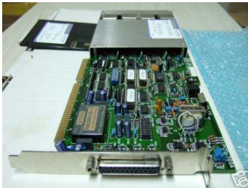
Σχήμα 2.8: Απεικόνιση κάρτας KYOWA PCD-200A (KYOWA, Instruction Manual)
