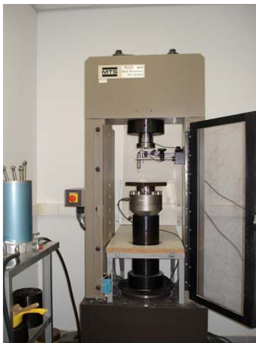
Σχήμα 2.1: Άκαμπτη συσκευή φόρτισης MTS Model 315.01 (MTS, 2004)
