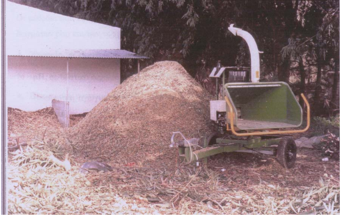
Εικόνα 3.1 Θρυμματιστής κλαδοκαθάρων με πετελαιοκινητήρα 27hp
