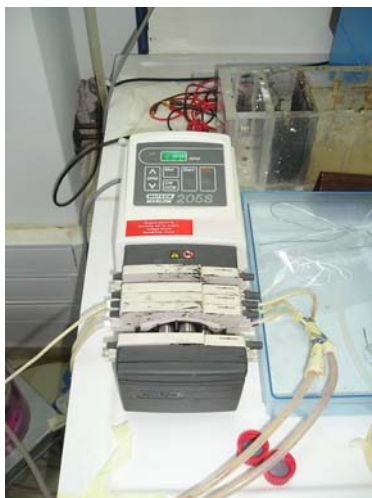
Εικόνα 2: Χρησιμοποιούμενη αντλία για την παροχή του προς επεξεργασία διαλύματος στις στήλες.
