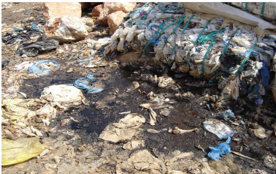
Εικόνα 32: Εξαιτίας της καταστροφής του περιτυλίγματος των δεματοποιημένων απορριμμάτων αλλά και της μη επικάλυψής τους, τα απορρίμματα έμειναν εκτεθειμένα στα κατακρημνίσματα με αποτέλεσμα την αύξηση της σχετικής υγρασίας των απορριμμάτων και την δημιουργία στραγγισμάτων
