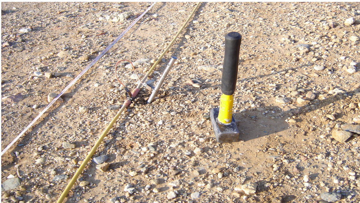
Εικόνα 45: Εγκαταστάθηκαν τα ηλεκτρόδια και συνδέθηκαν με τους ακροδέκτες
