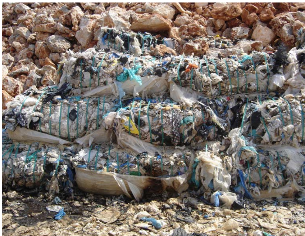
Εικόνα 20: Μερικά ακάλυπτα δεματοποιημένα απορρίμματα. Η ταινία περιτύλιξης όπως φαίνεται έχει καταστραφεί τελείως
