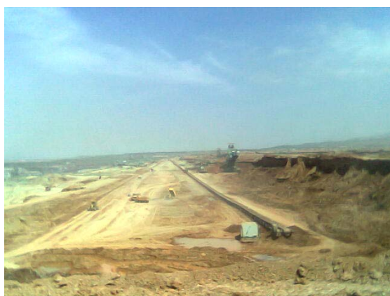
Εικόνα 2: Εξόρυξη λιγνίτη και μεταφορά με ταινιόδρομο στην Δυτική Μακεδονία (Φώτο Γιάννακας Ι. 2006).
