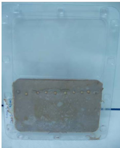
Σχήμα 4.5: Σχηματική απεικόνιση της πειραματικής διάταξης που χρησιμοποιήθηκε για την διεξαγωγή των πειραμάτων φυτοτοξικότητας.
