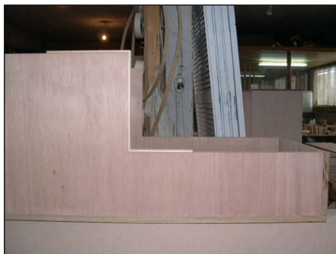
Εικόνα 4.1: Κοντινή άποψη ξύλινης κατασκευής «αμμοκιβωτίου» (sandbox) κατά την πρώτη φάση της κατασκευής αυτού
