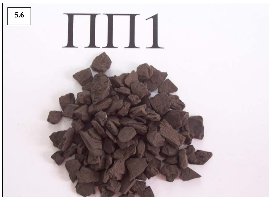
Εικόνες 5.5, 5.6.: Λιγνίτες ΚΠ1, ΚΠ2 & ΚΠ5 από τον Πλακιά και ΠΠ1 από την Πελλάνα. Υποβιτουμενιούχοι στιλπνοί γωνιώδεις και ξυλιτικοί στρωσιγενείς γωνιώδεις φθαρμένοι κόκκοι, αντίστοιχα.
