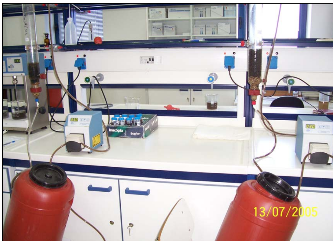
Εικόνα 6.1: Εργαστηριακός εξοπλισμός εν λειτουργία στη μελέτη της διεργασίας διήθησης. Διακρίνονται οι πρότυπες κλίνες πληρωμένες με διαφορετικές ποσότητες γαιάνθρακα, τα δοχεία της τροφοδοσίας και οι περισταλτικές αντλίες.
