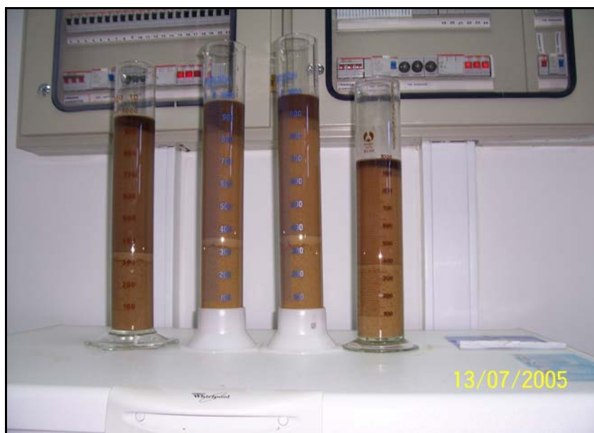
Εικόνα 6.2: Δείγματα κατσίγαρου μετά από καθίζηση 24 ωρών. Διακρίνονται οι ζώνες των καθιζάνοντων και των εν αιωρήσει συστατικών.
