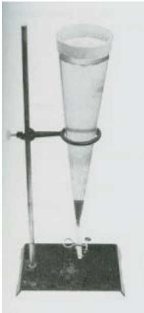
Σχήμα 4.4 : Ο κώνος Imhoff χρησιμοποιείται για το διαχωρισμό των σωματιδίων που βρίσκονται στα απόβλητα. Τα καθιζάνοντα στερεά είναι αυτά που κατακαθίζουν στον πάτο του κωνικού δοχείου [5].
