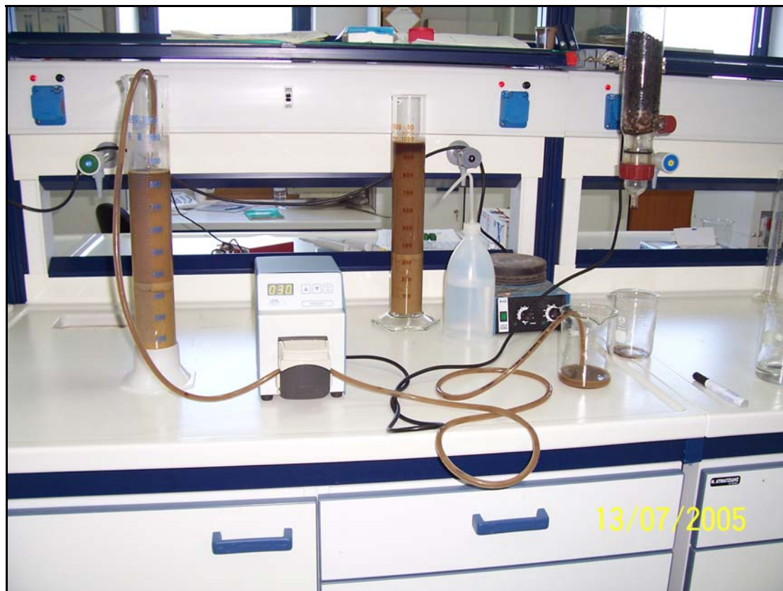
Εικόνα 6.3: Διαδικασία άντλησης και συλλογής της ποσότητας της τροφοδοσίας, με τη βοήθεια της περισταλτικής αντλίας.
