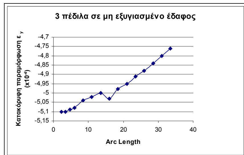
Σχήμα 8.86: Κατανομή κατακόρυφων παραμορφώσεων για επιβαλλόμενη τάση 0.01 \text{ kN/cm}^2
