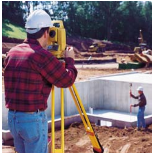
Σχήμα 5.2: Μέτρηση με ολοκληρωμένο γεωδαιτικό σταθμό.
