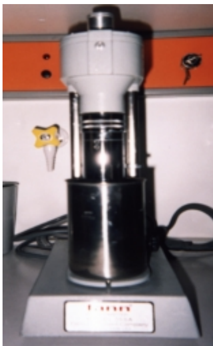
Εικόνα 5. 4: Ιξωδόμετρο Fann 35 S του Εργαστηρίου Πετρολογίας και Οικονομικής Γεωλογίας
