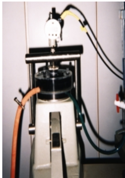
Εικόνα 5. 7: Συσκευή οιδημέτρου εμπρόστιας φόρτισης της Controls του Εργαστηρίου Εφαρμοσμένης Γεωλογίας (στάδιο μέτρησης πίεσης διόγκωσης)
