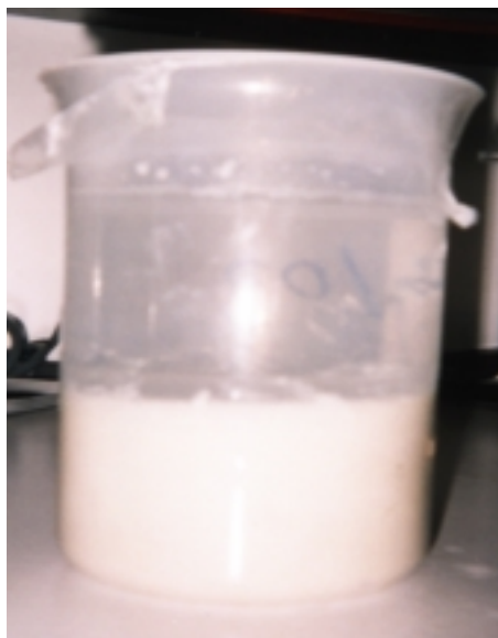
Εικόνα 5. 1: Κροκίδωση δείγματος μπεντονίτη σε διάλυμα \text{Ca}(\text{OH})_2
