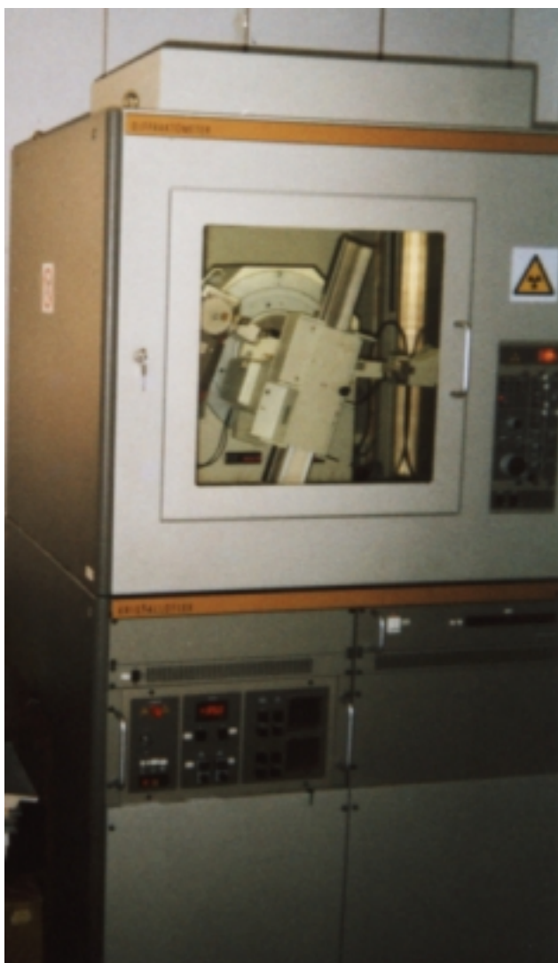
Εικόνα 5. 2: Περιθλασίμετρο ακτίνων-X, τύπου D500 της Siemens, του Εργαστηρίου Γενικής και Τεχνικής Ορυκτολογίας
