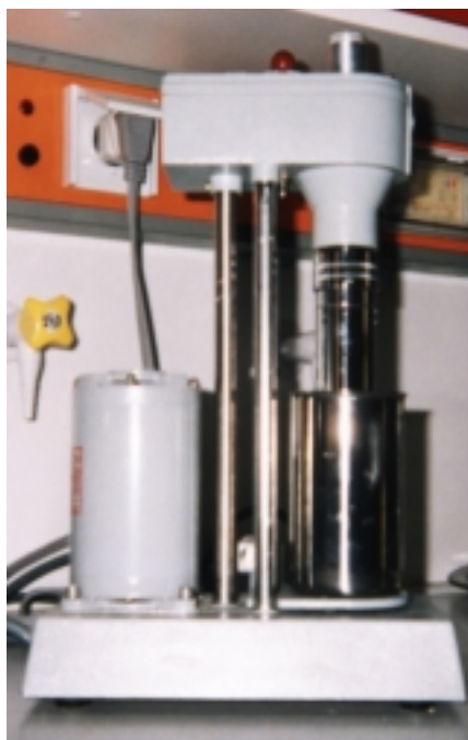
Εικόνα 5. 4: Ιξωδόμετρο Fann 35 S του Εργαστηρίου Πετρολογίας και Οικονομικής Γεωλογίας
