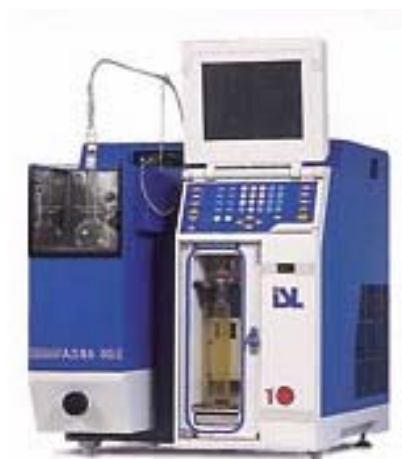
Εικόνα 2.2 : Αυτόματη αποστακτική συσκευή της ISL
