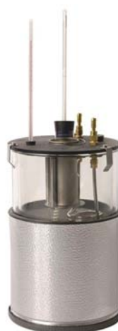
Εικόνα 2.4 : Διάταξη μέτρησης του σημείου ροής και του σημείου θολώσεως
