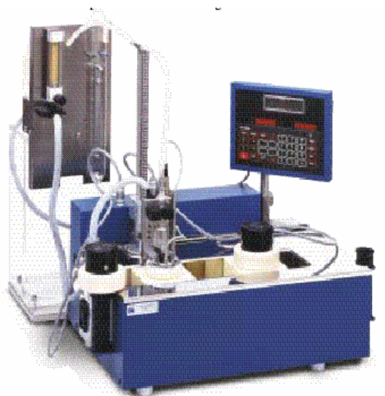
Εικόνα 2.5 : Αυτόματη συσκευή μέτρησης του σημείου αποφράξεως ψυχρού φίλτρου C.F.P.P της ISL
