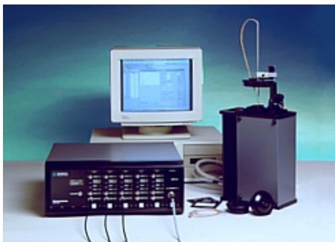
Σχήμα 1.8 :Το τελευταίο μοντέλο ενός HOT- WIRE ANEMOMETER της εταιρείας Dantec Dynamic.
