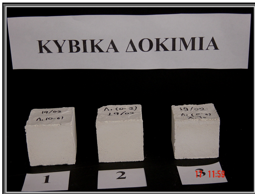
Φωτ.9. Κυβικά δοκίμια Kourasanit (βλ. αρίθμηση κεφ.8.1)
