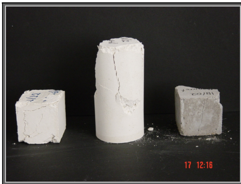
Φωτ.11. Κυβικά και κυλινδρικό δοκίμιο μετά την αντοχή σε μονοαξονική θλίψη
