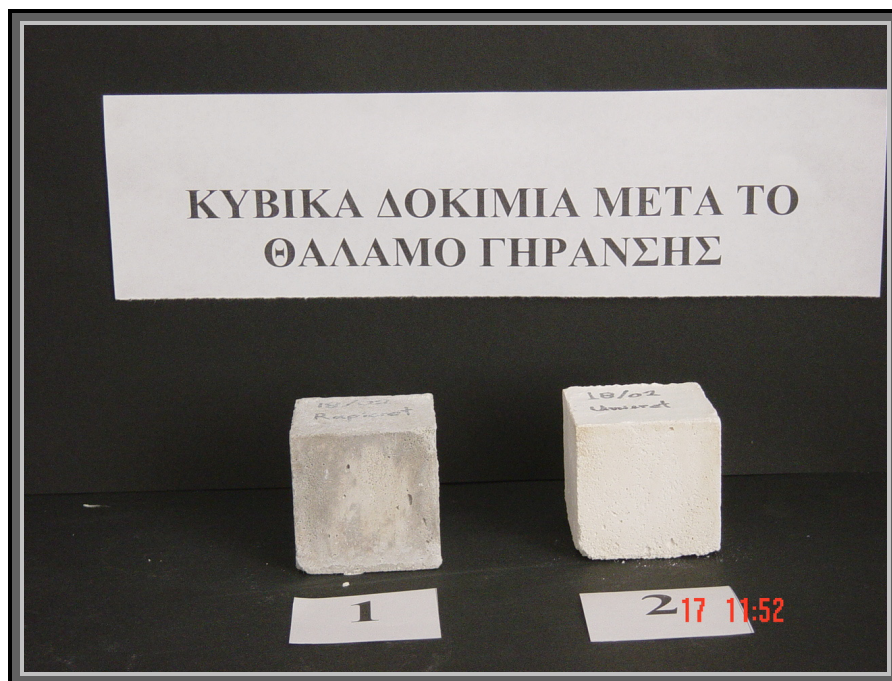
Φωτ.13. Τσιμεντοκονιάματα Rapicret (1) και Unicret-fast μετά το θάλαμο γήρανσης
