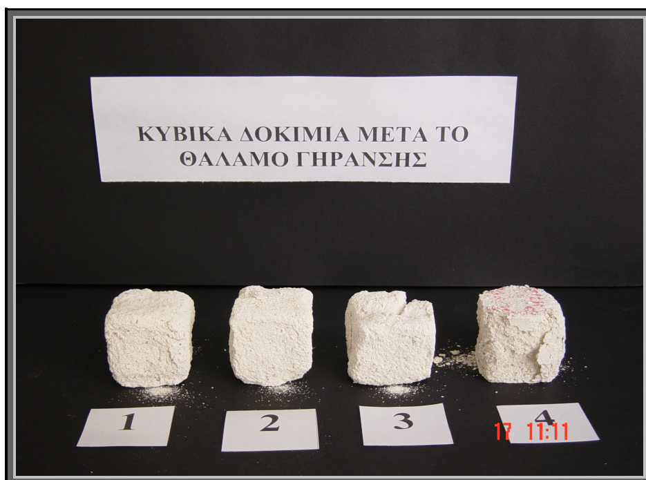
Φωτ.12. Κυβικά δοκίμια μετά το θάλαμο γήρανσης (βλ. αρίθμηση κεφ. 8.1)
