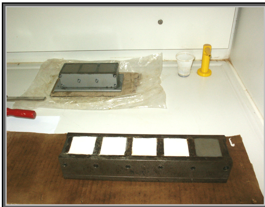
Φωτ.8. Τσιμεντοκονιάματα Unicret-fast και Rapicret σε μεταλλικά καλούπια
