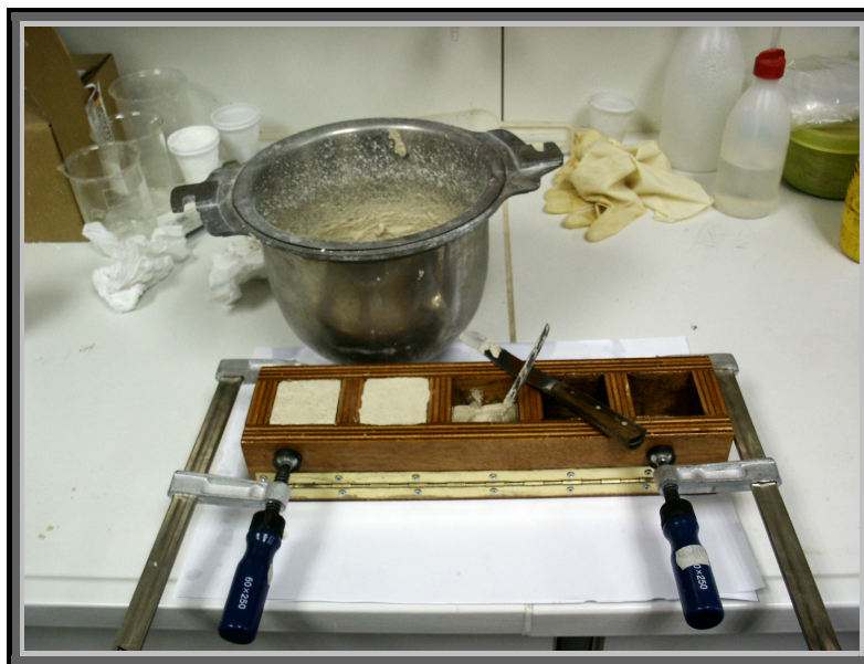
Φωτ. 8.2. Τοποθέτηση υλικού σε ξύλινα κυβικά καλούπια
