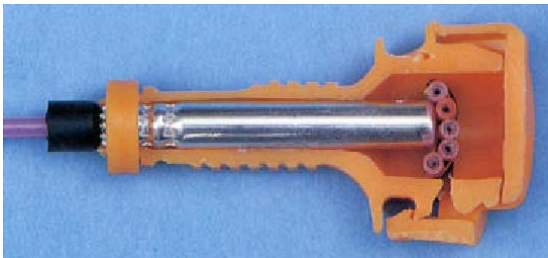
Σχ. 2.42: Σύνδεση πέντε αγωγών καψυλλίων NONEL με την γραμμή κατασκευής του κυκλώματος πυροδότησης με την βοήθεια συνδέσμου (Πηγή: Dynonobel, 2003).
