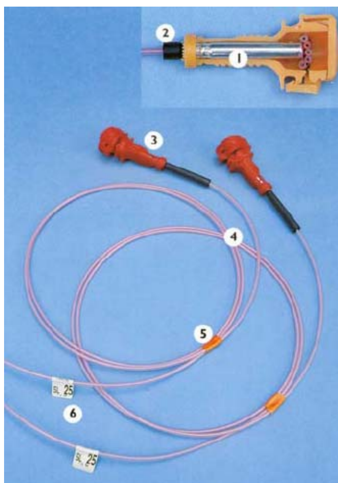
Σχ. 2.36: Σύνδεσμοι μονού τύπου του συστήματος NONEL με αγωγό μήκους 2,4 m (Πηγή: Dynonobel, 2003).
