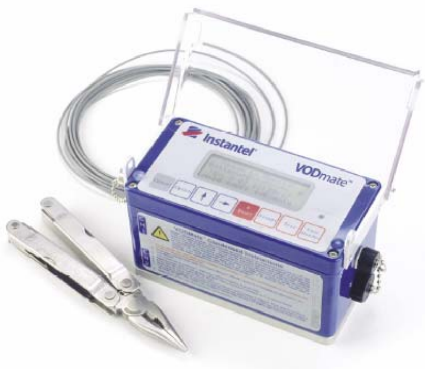
Σχ. 3.12: Συσκευή μέτρησης ταχύτητας έκρηξης VODmate της Instantel (πηγή: Instantel, 2003)
