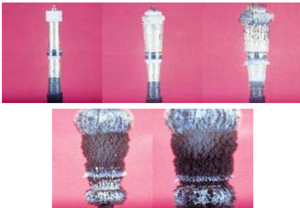
Σχ. 3.10 Έκρηξη ατσάλενιου κυλινδρικού καψυλλίου με μπρούντζινους δακτυλίους με ταχύτητα λήψης 1 εκατομμύριο καρέ το δευτερόλεπτο (Πηγή: Cordin, 2003)
