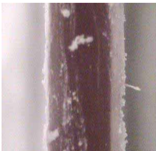
Σχήμα Π.6: Εικόνες από οπτικό μικροσκόπιο για κέρινο δείγμα με επικάλυψη, από σκόνη ζirkονίας πλήρως σταθεροποιημένης με Y_2O_3 που έχει υποστεί ξήρανση δια ψεκασμού, και έχει ποσοστό ισοπροπυλικής αλκοόλης 85%. (α) επιφάνεια επικάλυψης (β) όψη κάθετα στην επιφάνεια επικάλυψης
