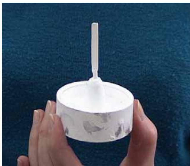
Σχήμα 2.2: Κέρινο δείγμα με κεραμική επικάλυψη.
