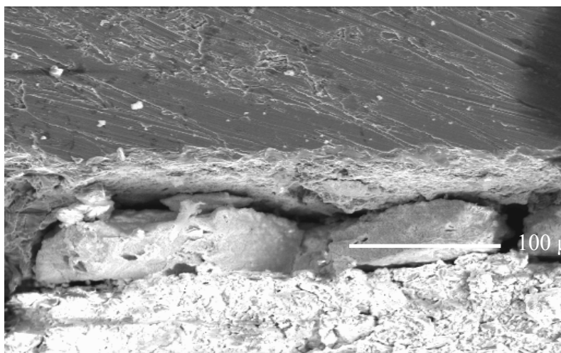
Σχήμα Π.11: Εικόνες από ηλεκτρονικό μικροσκόπιο σάρωσης δειγμάτων χυτού τιτανίου με επικάλυψη από σκόνη ζirkονίας πλήρως σταθεροποιημένης με Y_2O_3 που έχει υποστεί ξήρανση δια ψεκασμού και έχει ποσοστό ισοπροπυλικής αλκοόλης 90%
