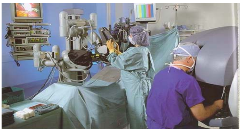
Εικόνα 2.19. Το ρομποτικό σύστημα Da Vinci. Ο χειρουργός καθοδηγεί τους βραχίονες μέσα από ειδική κονσόλα όπως και στο Zeus. Η κονσόλα προσφέρει αίσθηση της αφής και της δύναμης (tactile feedback).
