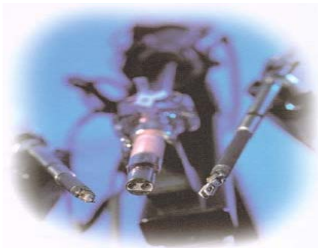
Σχήμα1.11 ΑΟι ρομποτικοί βραχίονες συγκρατούν δύο χειρουργικά εργαλεία και μία κάμερα. Τα εργαλεία έχουν 7 βαθμούς ελευθερίας και 2 περιστροφικής κίνησης. Το
