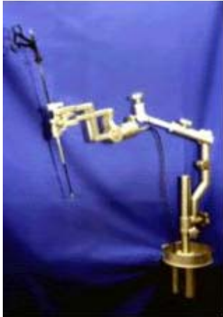
Εικόνα 2.11.Οπαθητικός βραχίονας TISKA.Οι αρθρώσεις του κλείδωναν με τη χρήση αερίου. Με το πάτημα ενός κουμπιού χαλάρωναν ταυτόχρονα.
