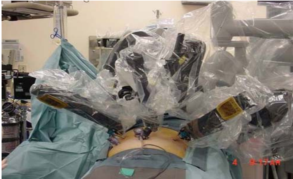
Σχήμα1.13Α Οι ρομποτικοί βραχίονες στη συνέχεια εισέρχονται στην κοιλιά του ασθενή μέσω των trocas
