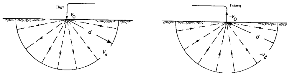
Σχ.2.2. Ροή ηλεκτρικού ρεύματος σε ομοιογενή και ισότροπη γη στην περίπτωση που δεν υπάρχει αλληλεπίδραση μεταξύ των δύο ηλεκτροδίων.
