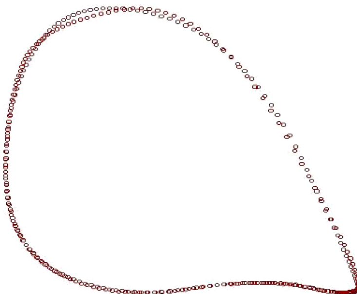
Σχήμα 4.2. – Σύγκριση της αεροτομής – στόχου και αυτής που προέκυψε με τη χρήση ΕΑ, για μεγαλύτερα διαστήματα τιμών για κάθε σημείο ελέγχου (δεύτερη εφαρμογή).
