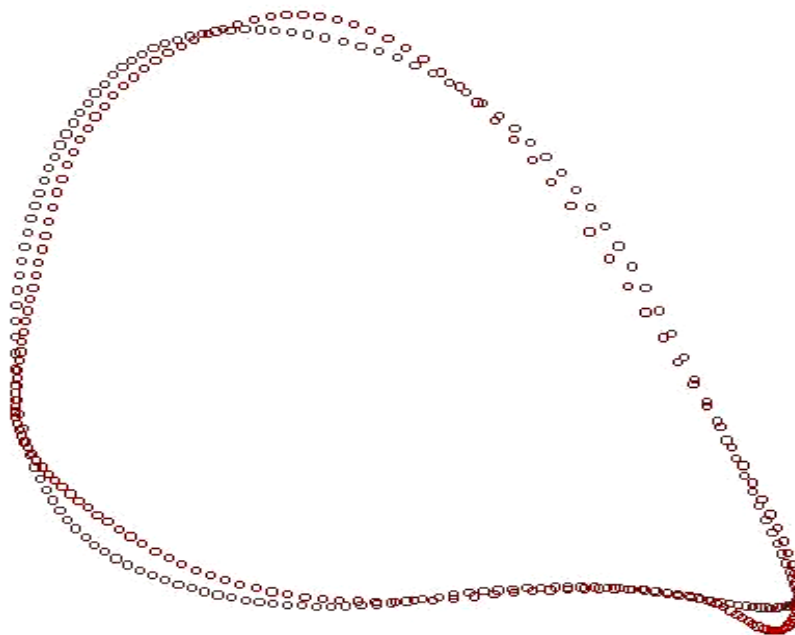
Σχήμα 5.1. – Η αεροτομή μετά από 15 επαναλήψεις του αλγορίθμου ( με κόκκινο) και ο στόχος που θέλουμε να προσεγγίσουμε (με γκρι).
