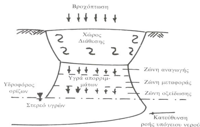
Σχήμα 18: Ρύπανση υπόγειου υδροφόρου ορίζοντα από υγρά απορρίμματα [15].
