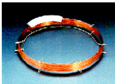
Εικόνα 14: Τριχοειδή στήλη επικαλυμμένη με \text{SiO}_2
