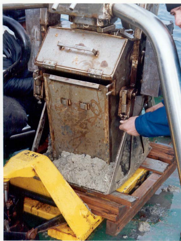
Εικόνα 5.2 Δειγματολήπτης (box corer)
