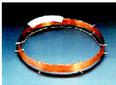
Εικόνα 12. Τριχοειδής στήλη Αέριου Χρωματογράφου
