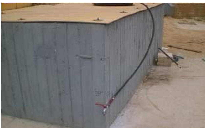
Εικόνα 21 Δειγματοληψία από έξοδο βιολογικού καθαρισμού (λάστιχο)
