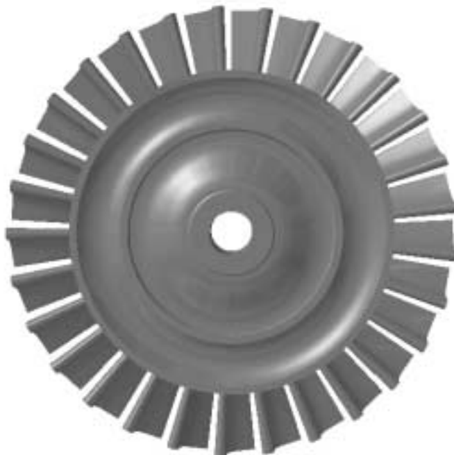
Εικόνα 3.33: Η ολοκληρωμένη μορφή της πτερωτής του στροβίλου.
