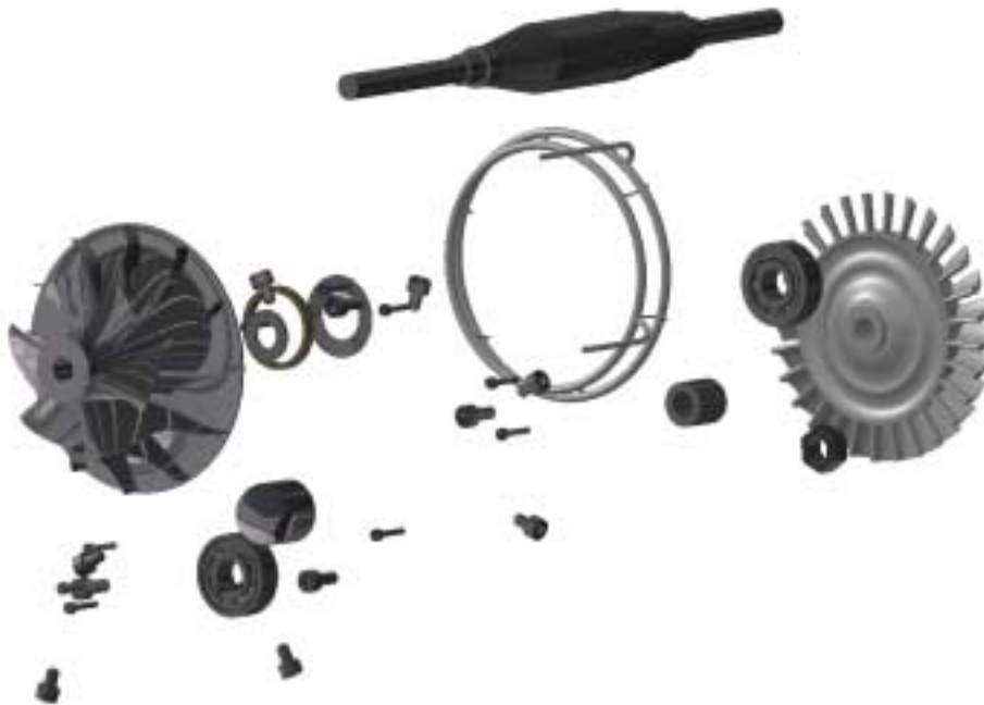
Εικόνα Π2.17: Ανάπτυξη των εσωτερικών τμημάτων του κινητήρα.
