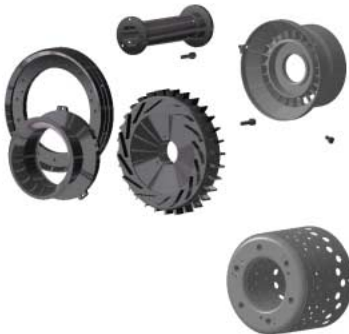
Εικόνα Π2.17: Ανάπτυξη των εσωτερικών τμημάτων του κινητήρα.
