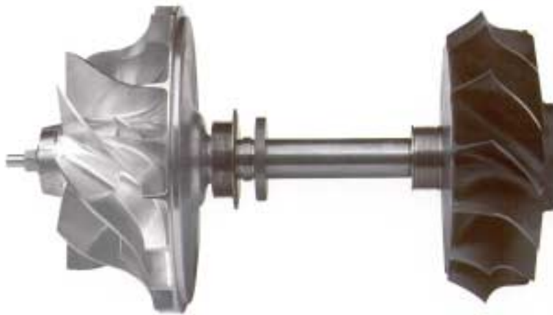
Εικόνα 2.9: Συγκρότημα πτερωτών συμπιεστή (αριστερά) και στροβίλου (δεξιά) ακτινικής ροής.
