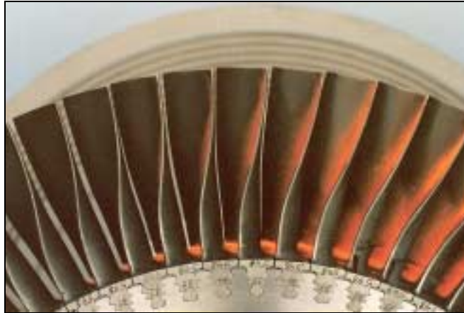
Εικόνα 2.8: Τμήμα πτερωτής (ρότορα) στροβίλου αξονικής ροής.
