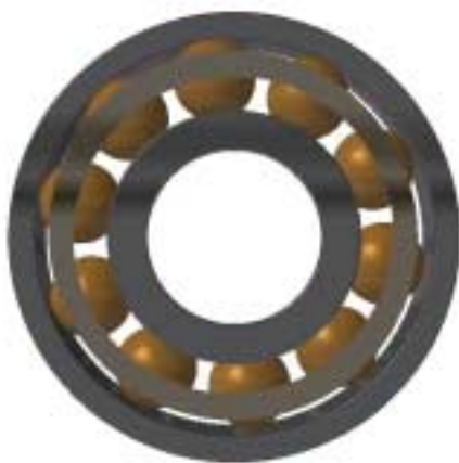
Εικόνα 3.26: Τελική, πλήρης μοντελοποίηση του εδράνου κύλισης.
