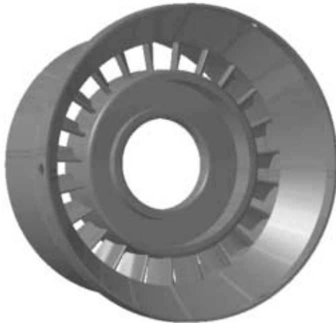
Εικόνα Π2.6: Το συγκρότημα των σταθερών πτερυγίων του στροβίλου (όψη από το εμπρός τμήμα).
