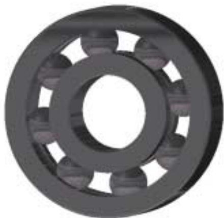
Εικόνα 3.25: Αρχική, απλοποιημένη μοντελοποίηση του εδράνου κύλισης.
