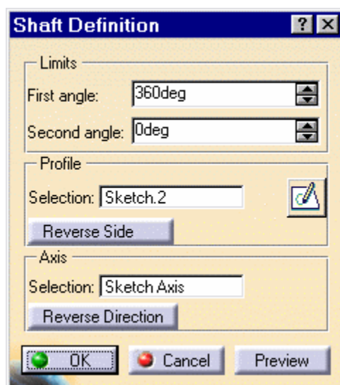
Εικόνα Π1.24: Παράθυρο διαλόγου, μέσω του οποίου πραγματοποιείται η εισαγωγή των μοιρών περιστροφής, της γενέτειρας γραμμής και του άξονα περιστροφής.
