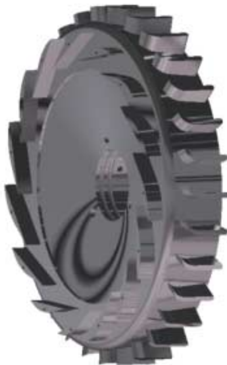
Εικόνα Π2.5: Το σώμα του διαχύτη του συμπιεστή.
