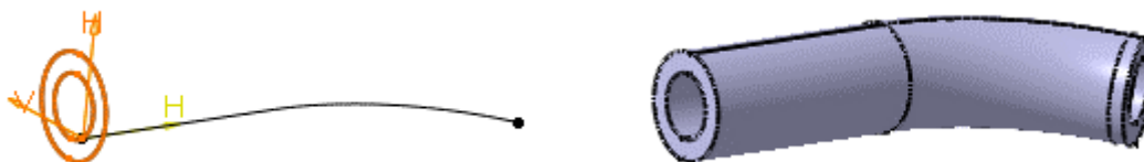
Εικόνα Π1..28: Παράδειγμα εφαρμογής της εντολής RIB.
