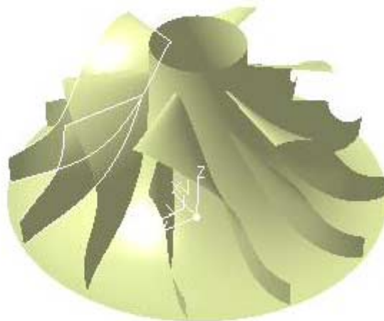
Εικόνα 3.14: Η τελική μορφή της πτερωτής του συμπιεστή (με μηδενικό πάχος πτερυγίων).
