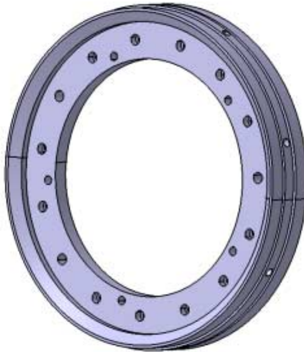
Εικόνα 3.35: Η τελική μορφή του κελύφους του διαχύτη, μαζί με όλες τις αναγκαίες οπές.
