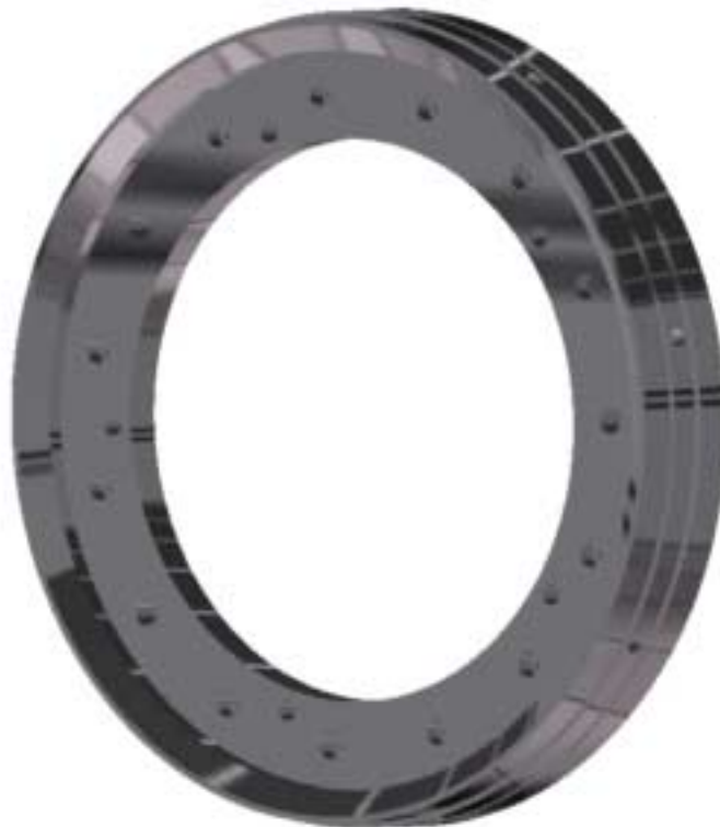
Εικόνα Π2.9: Το κέλυφος του διαχύτη του συμπιεστή.
