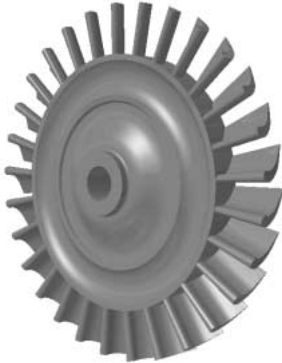
Εικόνα 4.9: Τελική μορφή της περωτής του στροβίλου.
