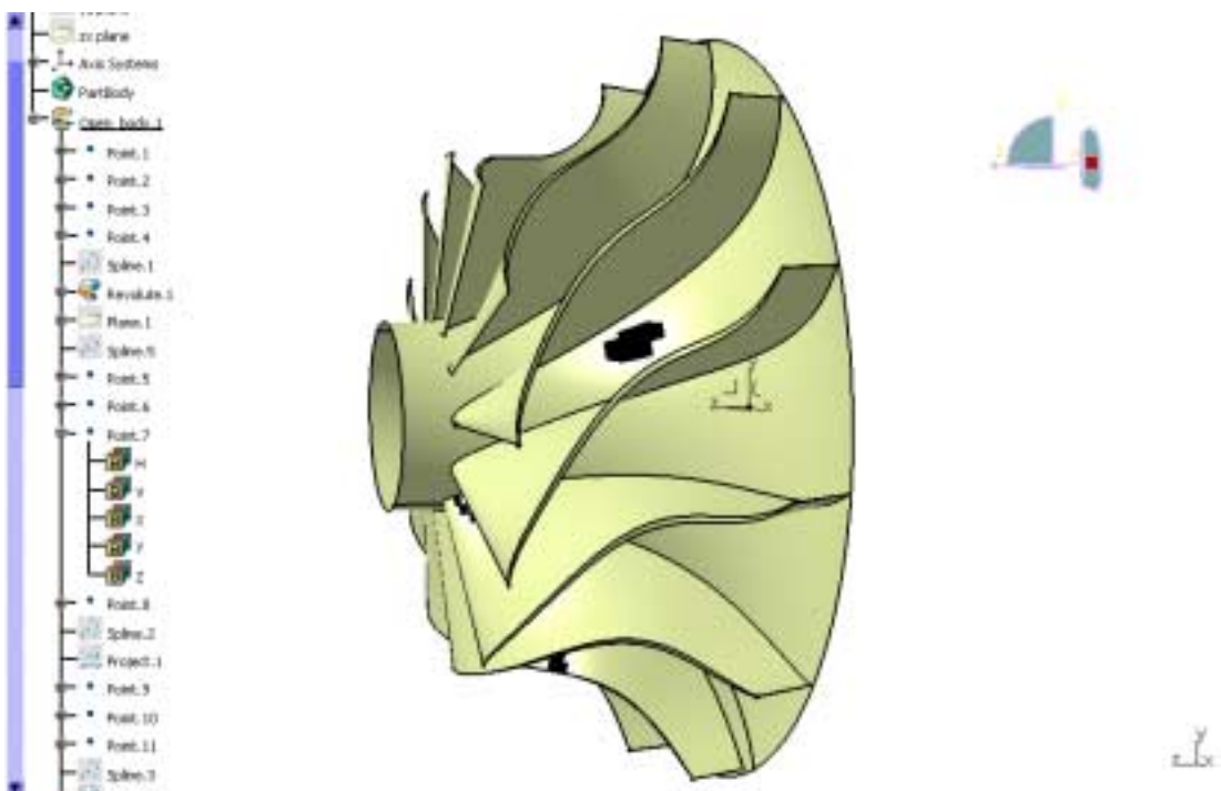
Εικόνα 4.6: Συμπιεστής με μεταβλητό πάχος πτερυγίων.
