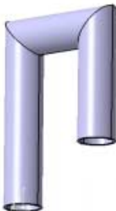
Εικόνα 3.23: Σωλήνας εξάχνωσης του καυσίμου.
