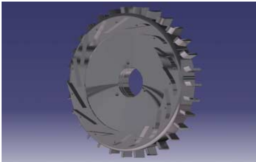
Εικόνα 3.9: Τελική μορφή του διαχύτη, όπου διακρίνονται τα μετωπικά και τα περιφερειακά πτερύγιά του.
