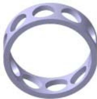
Εικόνα 3.29: Τελική μορφή του δακτυλίου συγκράτησης των σφαιρικών τριβέων.
