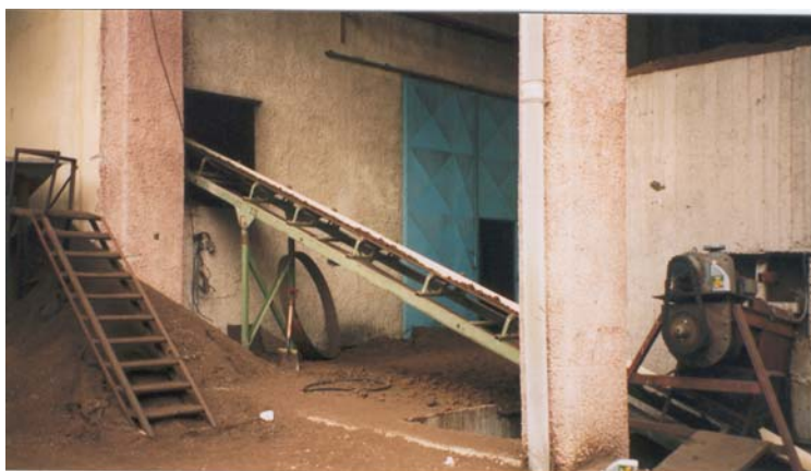
Εικόνα 3-2 Μηχανισμός Εναπόθεσης Πρώτης Ύλης στην Μεταφορική Ταινία
