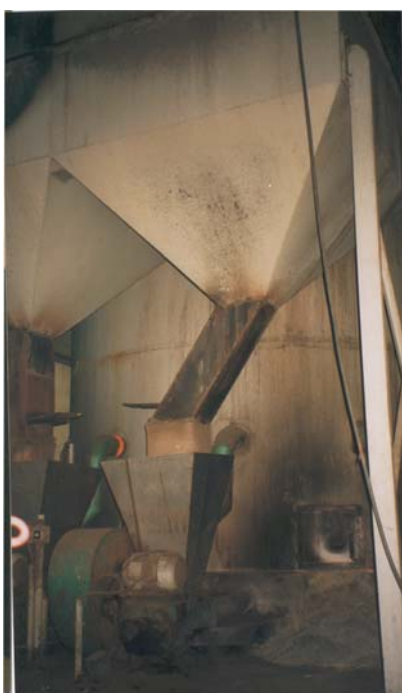
Εικόνα 3-4 Εισαγωγή Πυρηνόξυλου στον καυστήρα και ένωση του με Κλίβανο
