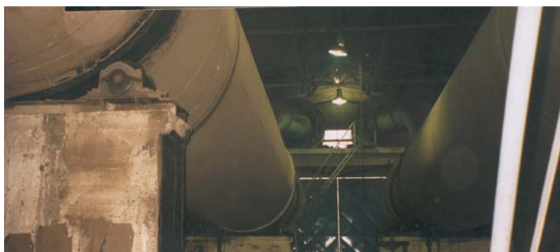
Εικόνα 3-7 Σύνδεση Ανεμιστήρων με τους Περιστροφικούς Ξηραντήρες
