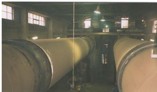
Εικόνα 3-6 Οι δύο Περιστροφικοί Ξηραντήρες
