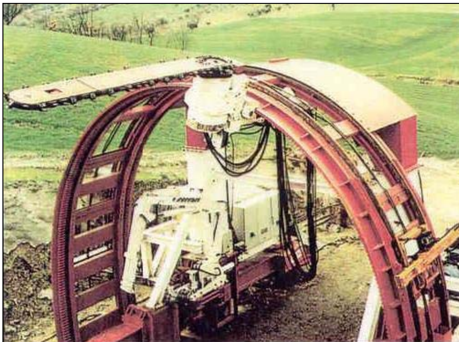
Σχήμα 2.17: Μηχάνημα περιφερειακής πρότμησης (Peila et al , 2006)
