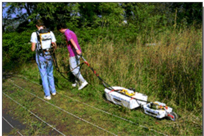
Εικόνα 6.4: Διεξαγωγή έρευνας υπεδάφειου ραντάρ με το σύστημα μονάδων RAMAC/GPR, βορειοανατολικά της περιοχής ρύπανσης 'Terme Romane', Monfalcone.
