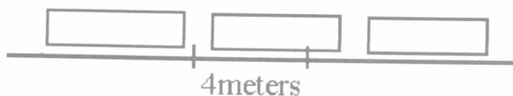
Σχήμα 5.19 Περίπτωση δημιουργίας ουράς στο φωρατή
