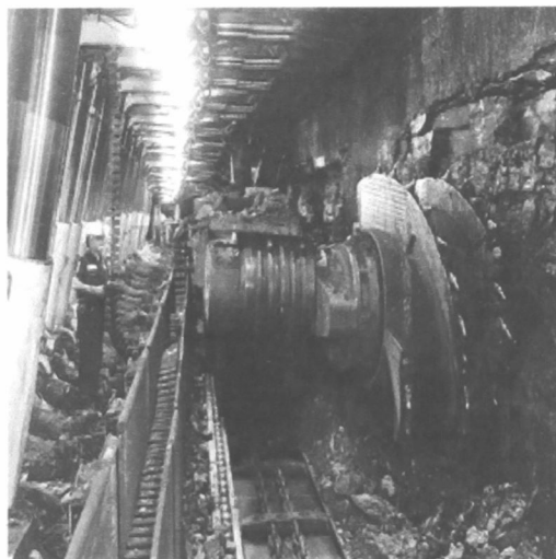
Σχήμα 2.7: Ο εξοπλισμός που χρησιμοποιείται στο μέτωπο κατά την μέθοδο των ευθύγραμμων μετώπων (UOW, 2002).
