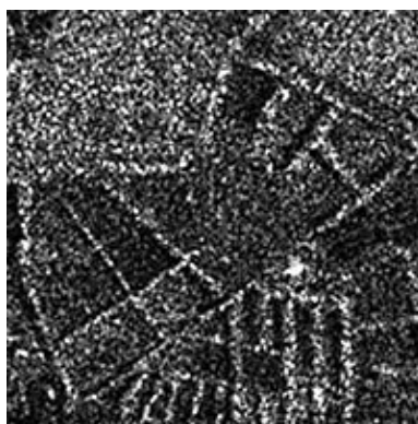
Σχήμα 4.21 Στίγματα (speckles) σε εικόνα Radar.
