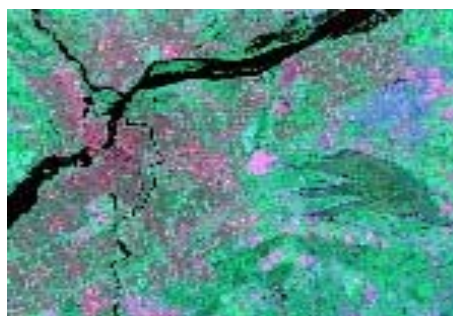
Σχήμα 5.13 Βελτίωση της αντίθεσης με διάταση του ιστογράμματος.
