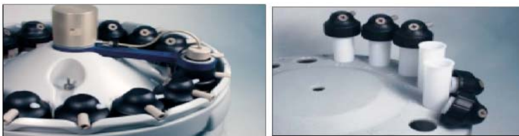
Εικόνα 35. Τα vessel με δείγματα και το vessel αναφοράς με τον αισθητήρα, τοποθετημένα μέσα στο ρότορα.
