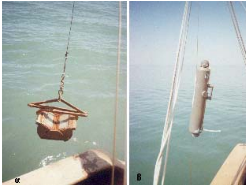
Εικόνα 30. Μηχανικό dredging για τη συλλογή ιζημάτων από τις διάφορες περιοχές δειγματοληψίας του Θερμαϊκού κόλπου (α) και συλλογή νερού από τα σημεία δειγματοληψίας (β).
