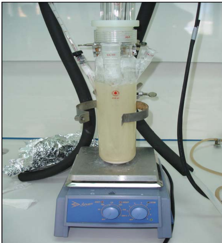
Σχήμα 3.3: Αντιδραστήρας εργαστηριακής κλίμακας της Ace glass μετά το τέλος πειράματος
