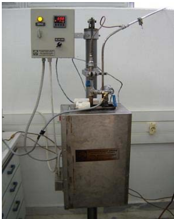
Εικόνα 9: Ο φούρνος στον οποίο λαμβάνει χώρα η αεριοποίηση της παραγόμενης πάστας
