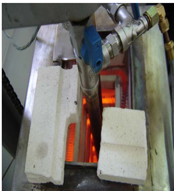
Εικόνα 10: Στην εικόνα φαίνεται η άνοψη του φούρνου, με τον κυλινδρικό αντιδραστήρα να διακρίνεται μετά την είσοδό του στον εσωχώρο του φούρνου
