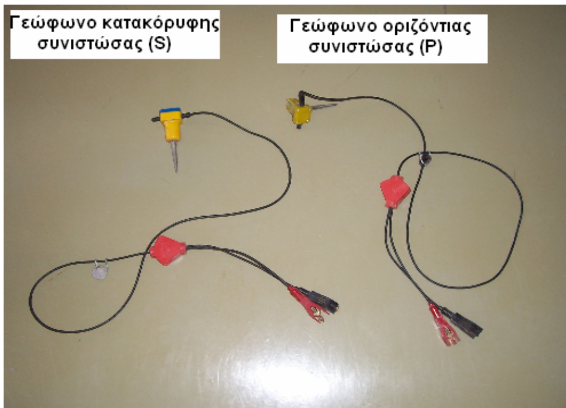
Σχήμα 5.4 Γεώφωνα που χρησιμοποιήθηκαν στις σεισμικές διασκοπήσεις.
