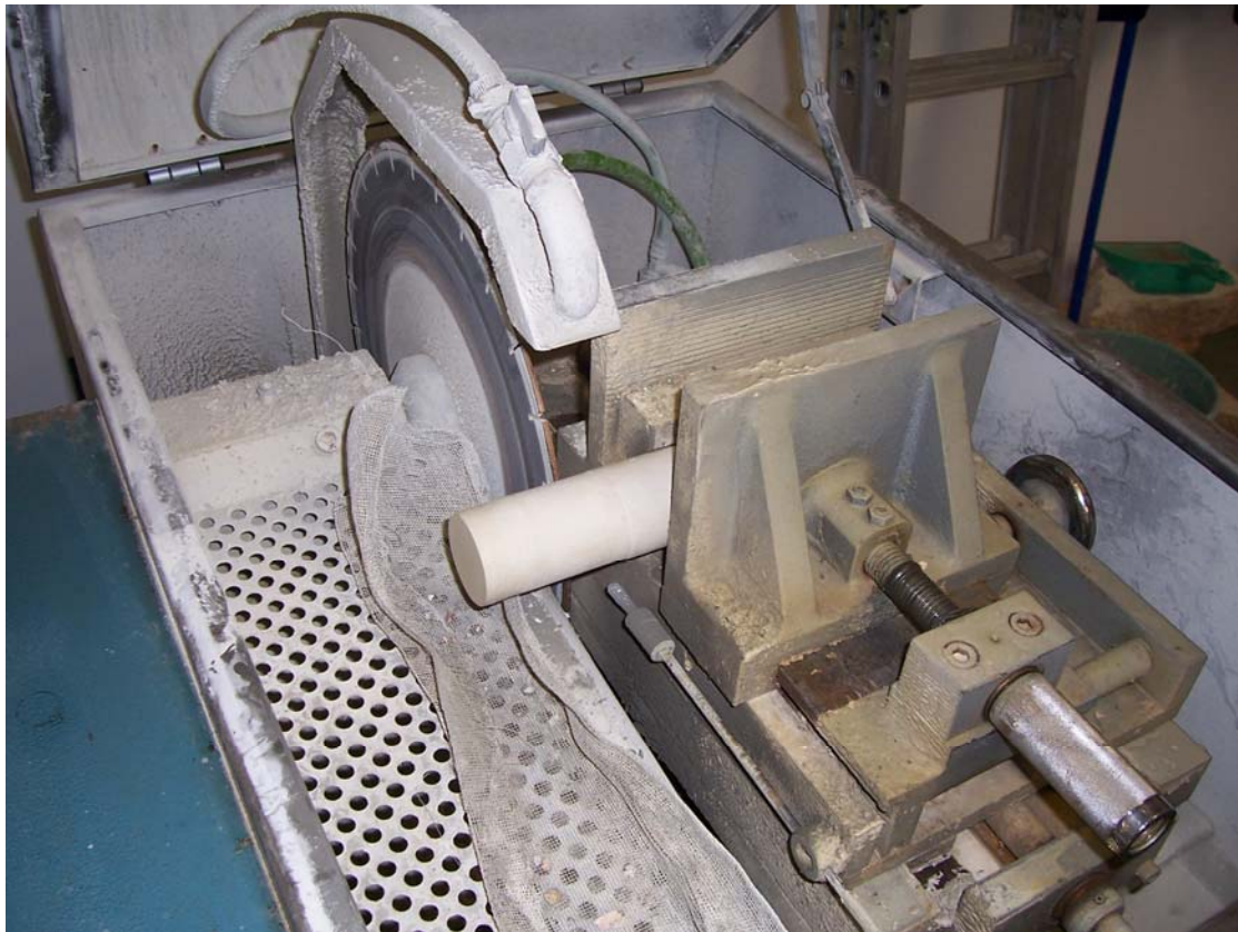
Σχήμα 4.5 Εργαστηριακό δισκοπρίνο κοπής δοκιμίων πετρωμάτων.
