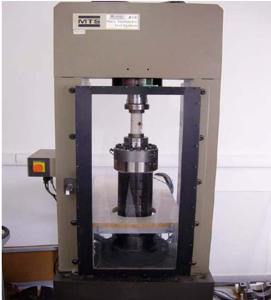
Σχήμα 4.7 Συσκευή φόρτισης MTS 1600 kN.
