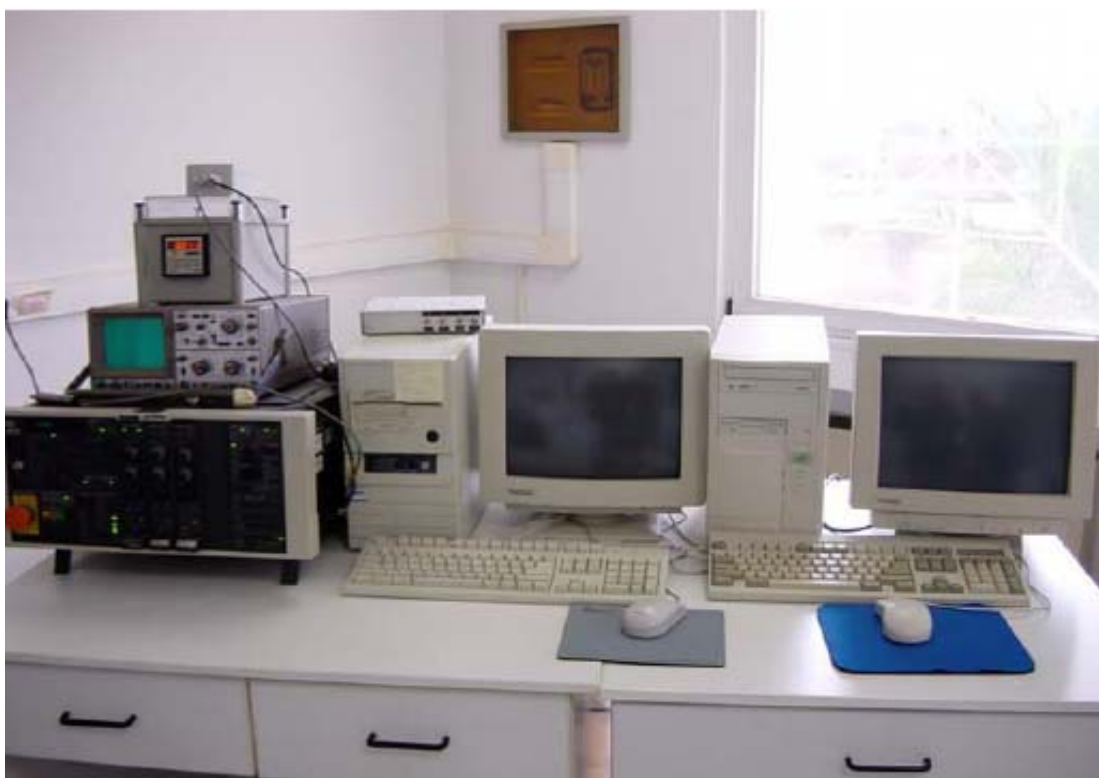
Σχήμα 4.8 Ολοκληρωμένο σύστημα καταγραφής δεδομένων ανεμπόδιστης μονοαξονικής θλίψης.
