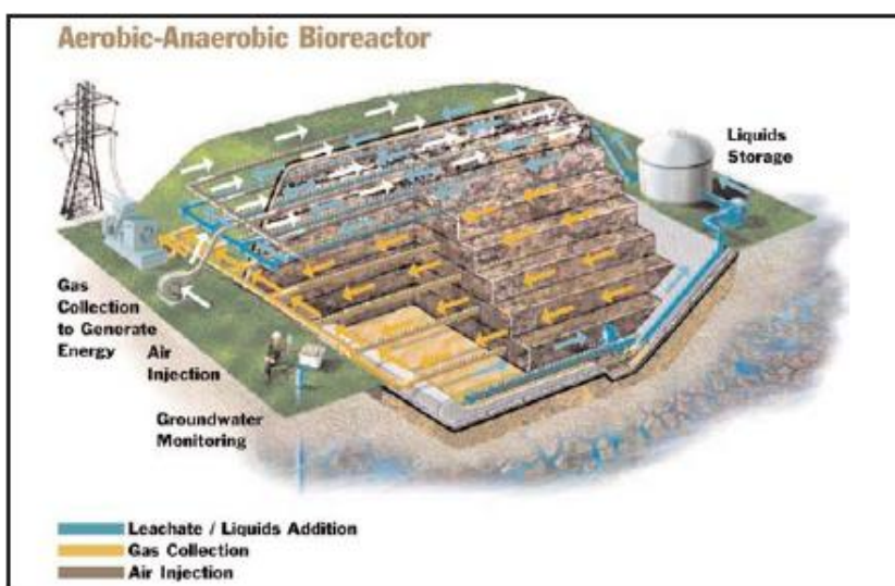
Εικόνα 3- 5: Σχηματική απεικόνιση υβριδικού βιοαντιδραστήρα απορριμμάτων (EPA,2002)
