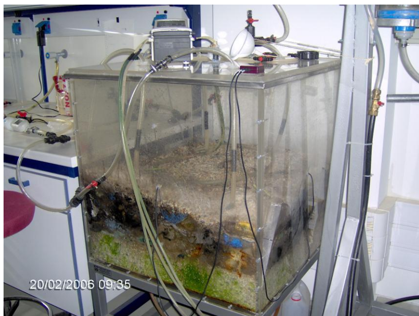
Εικόνα II-1: Εργαστηριακός βιοαντιδραστήρας
