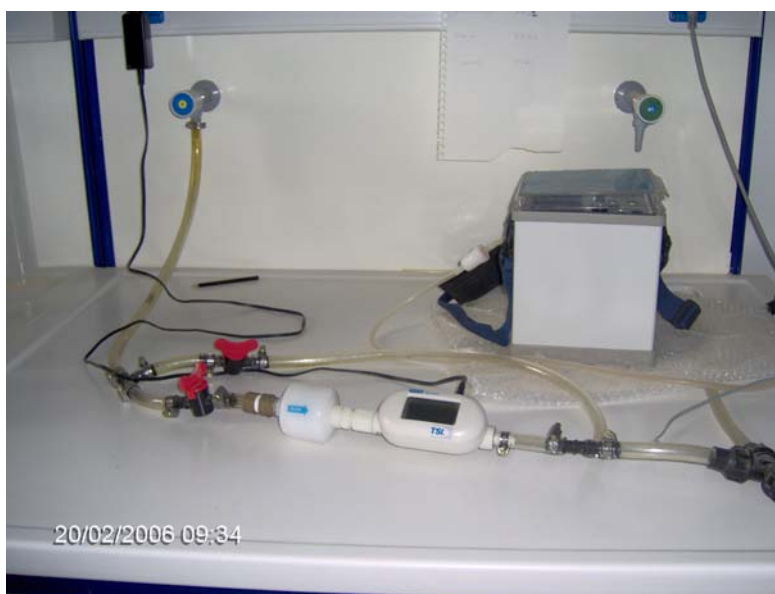
Εικόνα II-10: Σύστημα αερισμού βιοαντιδραστήρα
