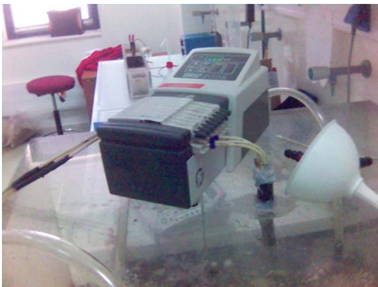
Εικόνα II-7: Αντλία ανακυκλοφορίας στραγγισμάτων
