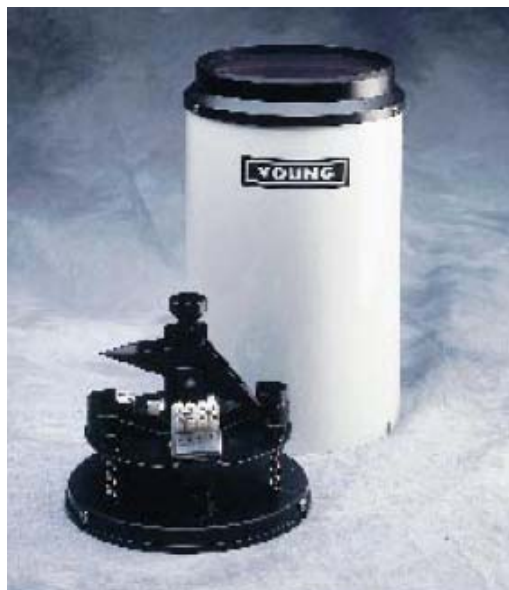
Εικόνα 4-2: Βροχογράφος ανατρεπόμενου κάδου
