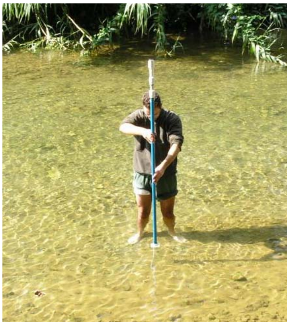
Εικόνα 4-15: Μέτρηση ταχύτητας ροής με το μυλίσκο
