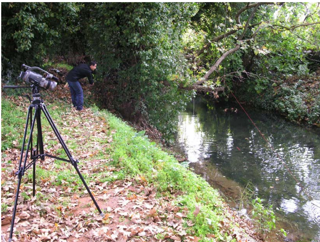
Εικόνα 4-16: Μέτρηση ταχύτητας ροής με την ψηφιακή βιντεοκάμερα
